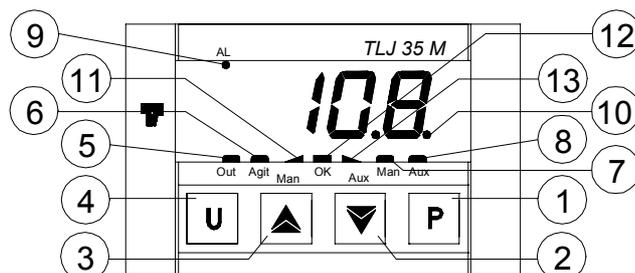
**1 - Tasto P** : Utilizzato per l'impostazione del Set point e per la programmazione dei parametri di funzionamento
