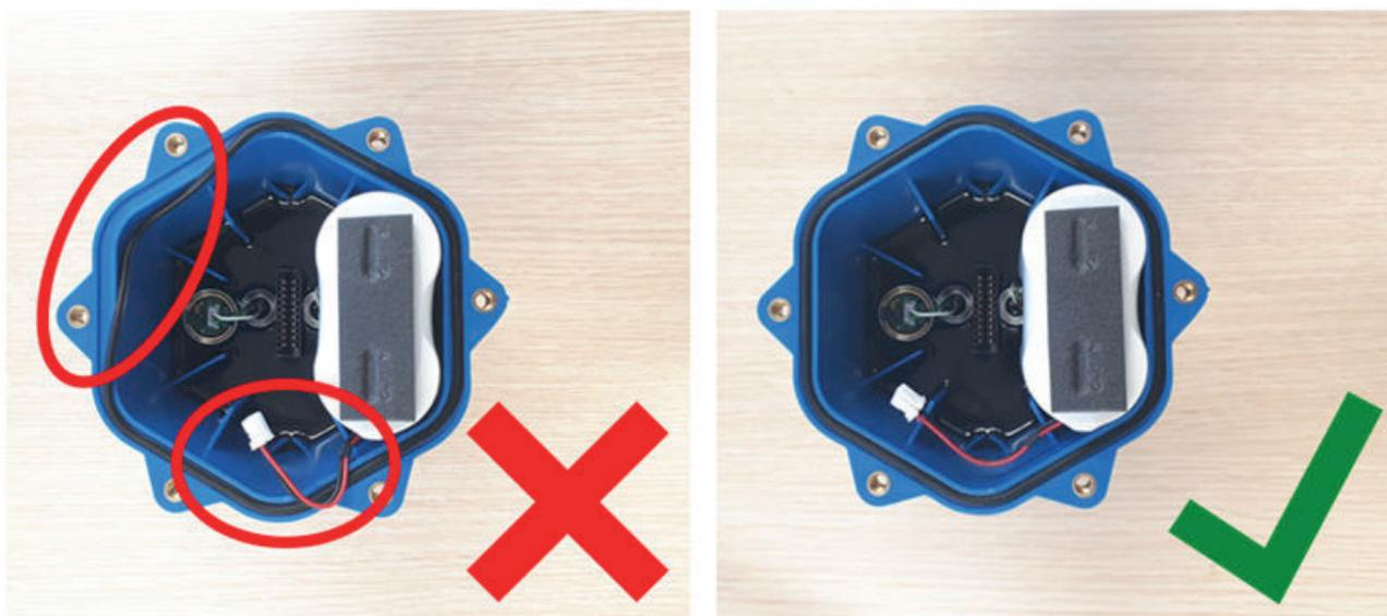
3. Ao introduzir o conjunto tampa+placa eletrónica preste especial atenção à marca de posicionamento.
